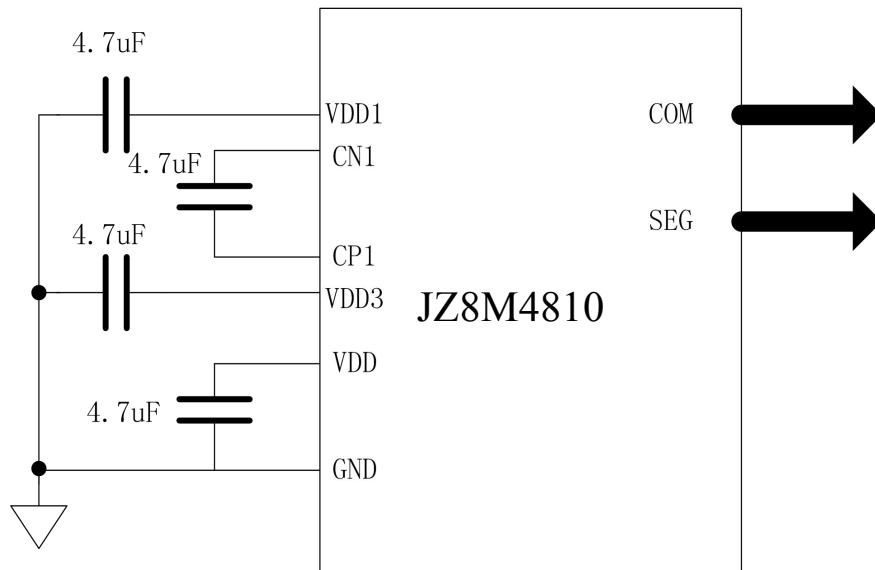
VDD1=VDD/2; VDD3=1.5VDD; 1/2 Bias 模式下 VDD3 电容可以不连接
