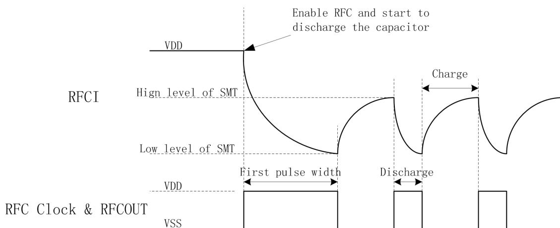
RFCOUT 输出到 TC2 的门控端进行脉宽计算，或输出到 TC2 的外部时钟输入端进行频率计算；通过测量各个 Sensor 的脉冲宽度及参考电阻值，可以计算各个传感器的电阻。
